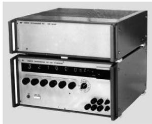
Предназначен для автоматизированной поверки и разбраковки на постоянном токе аналоговых и цифровых амперметров, вольтметров, ваттметров, измерения постоянного напряжения и сопротивления постоянному току, а также выполняет следующие функции:
